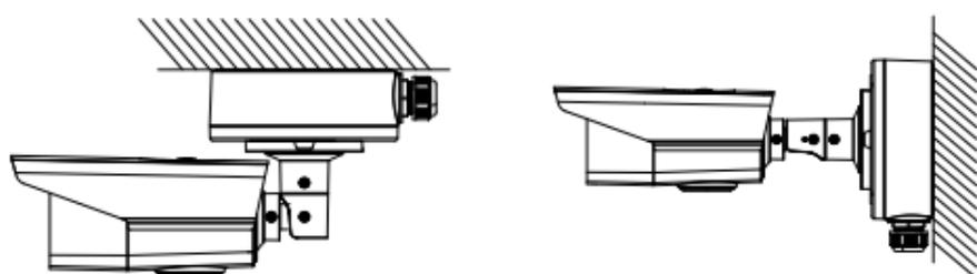
Рисунок 2-6 Установка камеры на стену/потолок
