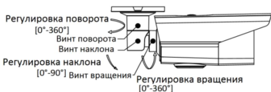
Рисунок 2-3 3-х осевая установка
