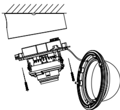
Рисунок 2-14 Закрепление камеры на основании
