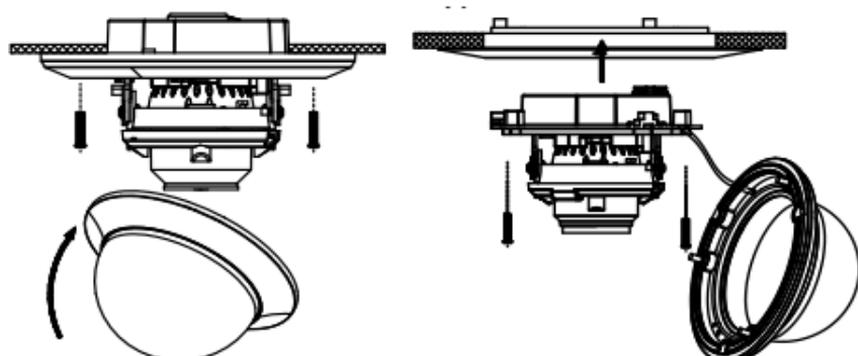
Рисунок 2-12 Закрепление камеры (Слева) Камера II типа, (Справа) Камера III типа
