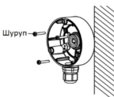
Рисунок 2-5 Установка монтажной коробки
