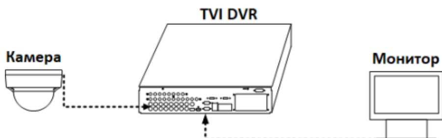
Рисунок 2-15 Схема подключения
