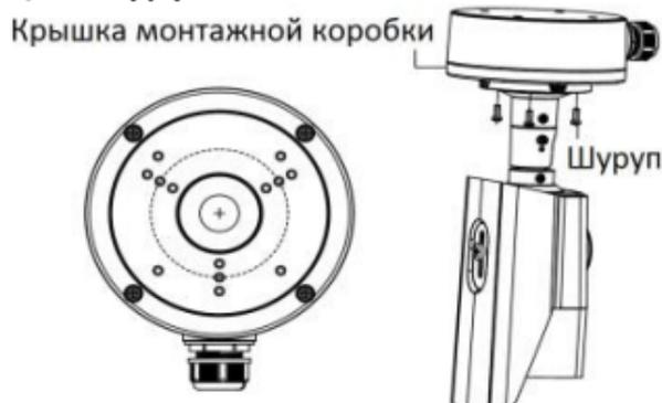
Рисунок 2-4 Установка камеры с монтажной коробкой
